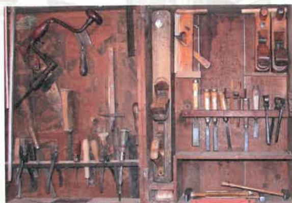
Mizarsko ročno orodje za žaganje, skobjenje, dletenje in dolbljenje ter vrtanje iz zbirke Adlja Bevca. Fotografirano leta 2018.
